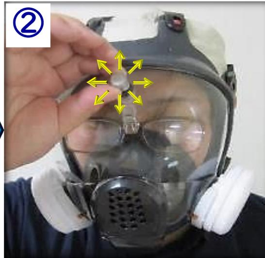
② 全面マスクを装着した後、必要に応じて、外側用の把持機構を動かし、メガネの位置を微調整する。
